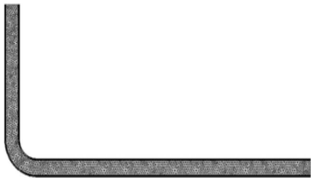
Figure 2. Bending pipe grid division 图 2. 弯管网格划分
