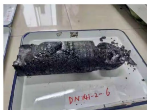
(d) DN141 井, J1b, 3014.73~3015.01 m, 光亮煤, 黑色沥青光泽, 镜煤和亮煤占比 87%
