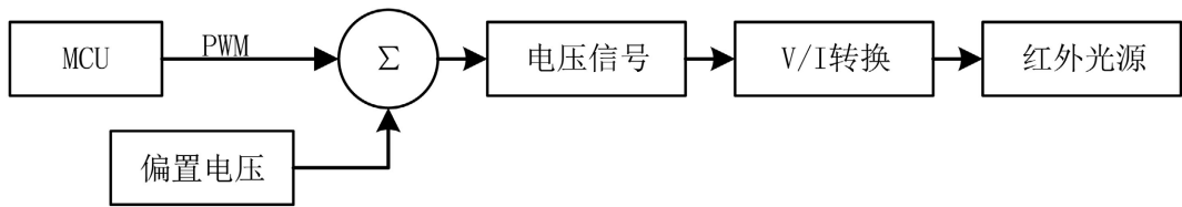
Figure 5. Light source drive circuit block diagram 图 5. 光源驱动电路框图
