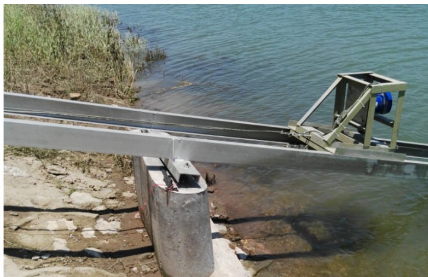
Figure 2. H-ADCP installation diagram 图 2. H-ADCP 安装示意图
