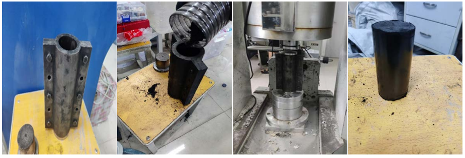
Figure 3. Preparation process of briquette 图 3. 型煤制备过程
