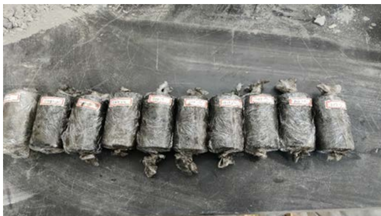
Figure 4. Briquette with different moisture content 图 4. 不同含水率成型型煤
