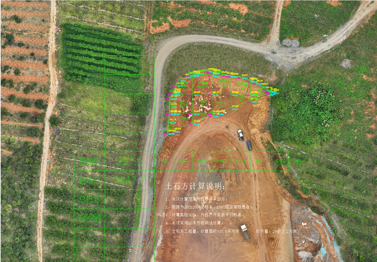
Figure 8. Calculation of total volume of mining loss using CASS software grid method 图 8. 使用 CASS 软件方格网法计算采损部分总方量
