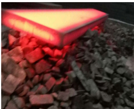
Figure 4. Raw materials are baked using hot steel billets 图 4. 原料使用热钢坯进行烘烤
