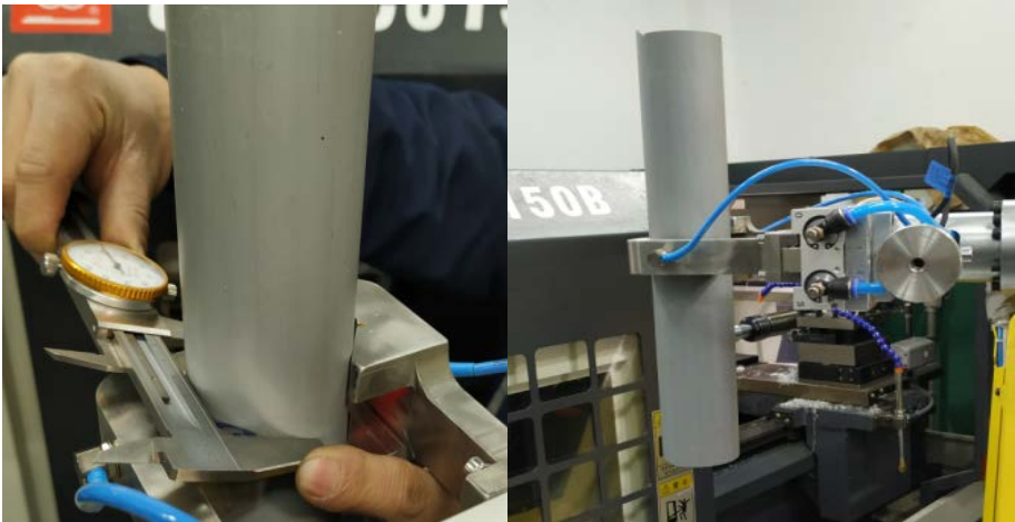
Figure 9. Clamping force test 图 9. 夹持力试验
