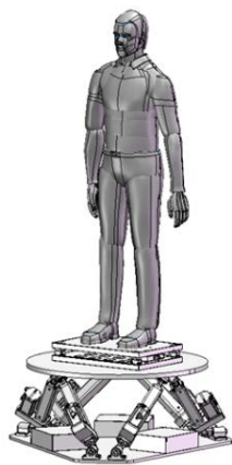
Figure 2. Six-degree-of-freedom Stewart platform 图 2. 六自由度 Stewart 平台
