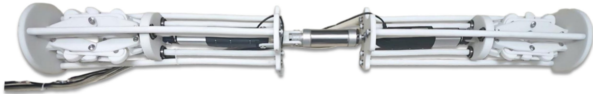
Figure 10. Principle prototype of the adaptive pipeline robot 图 10. 自适应管道机器人原理样机
