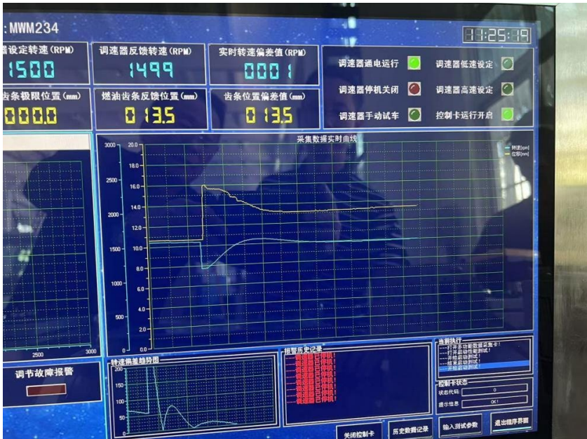
Figure 6. Schematic diagram of sudden load test 图 6. 突加负荷试验示意图
