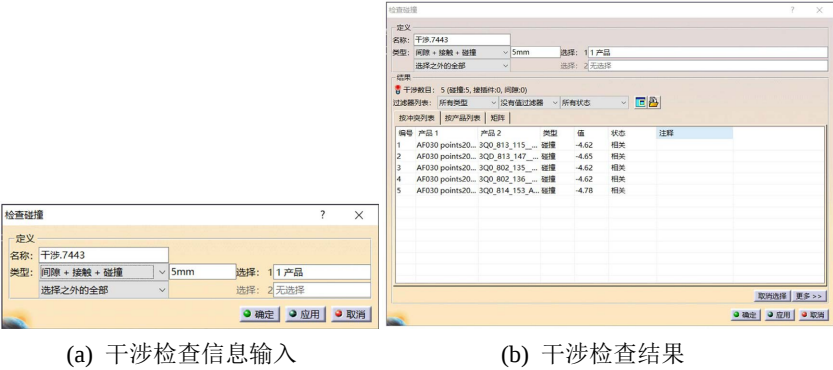
Figure 5. Interference check 图 5. 干涉检查
