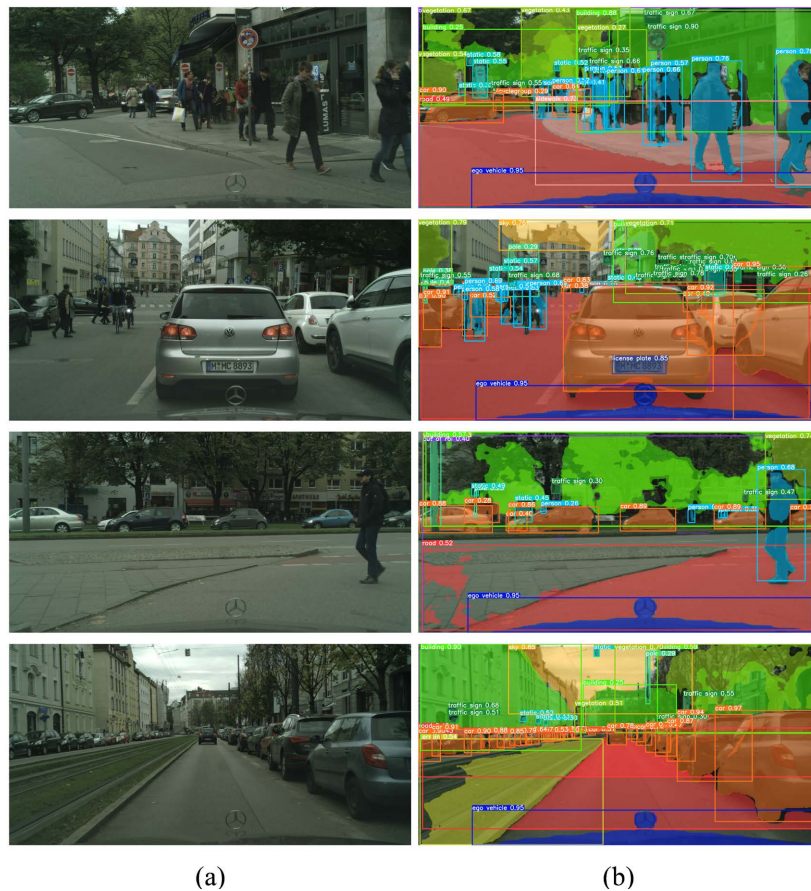
Figure 8. (a) Original test drawing; (b) segmentation effect drawing 图 8. (a) 原始测试图; (b) 分割效果图
