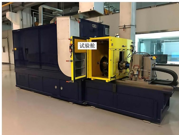
Figure 10. Brake disc inertia test bench 图 10. 制动盘惯性试验台
