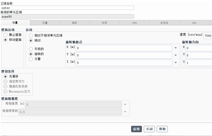
Figure 2. Outer wall surface setting 图 2. 外壁面设置
