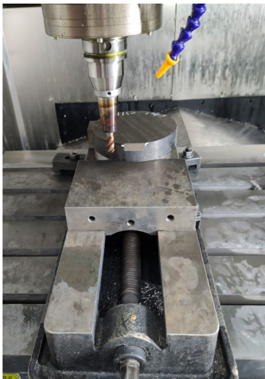
Figure 3. On-site photo of superalloy side milling test 图 3. 高温合金侧铣试验现场图
