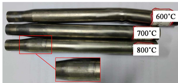
Figure 2. Parts formed at different temperatures 图 2. 不同加热温度下的成形零件
