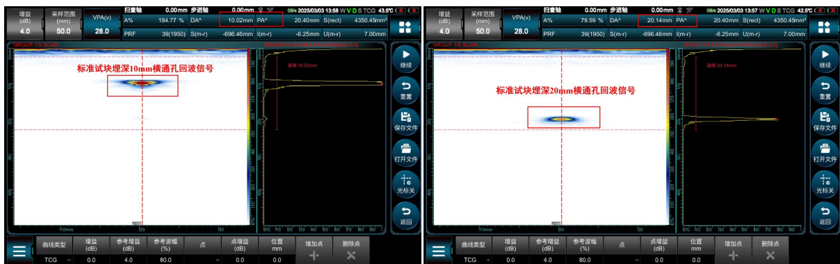
Figure 4. Location of transverse holes at various depths 图 4. 不同深度横通孔定位
