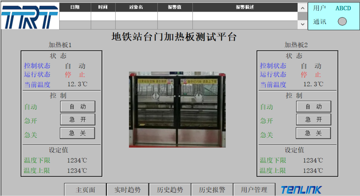
Figure 2. UI of the edge control system 图 2. 边缘控制系统显示界面
