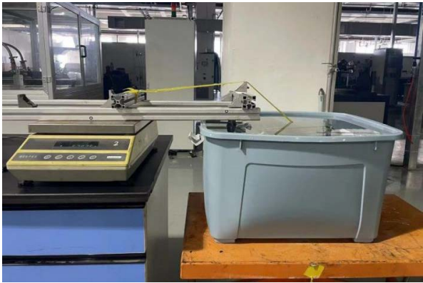
Figure 3. Photo from the Displacement test 图 3. 排水量试验中照片
