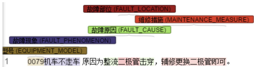
Figure 2. Maintenance case study 图 2. 维修案例分析
