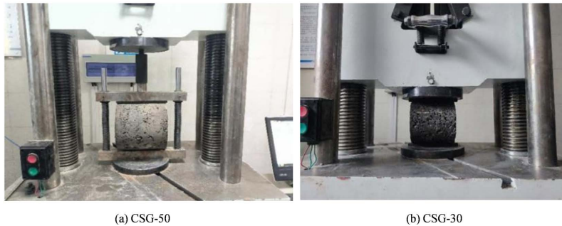
Figure 3. Splitting tensile test diagram 图 3. 劈裂试验图
