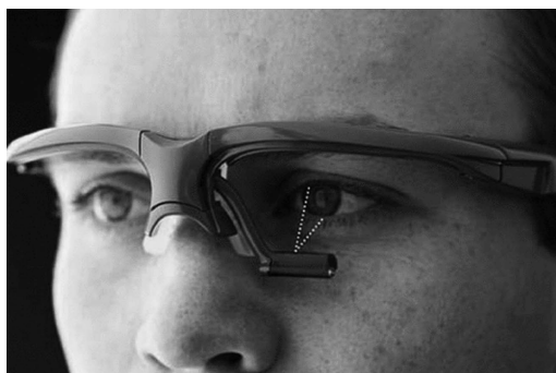
Figure 2. Working principle diagram of IOG 图 2. IOG 的工作原理图 2
