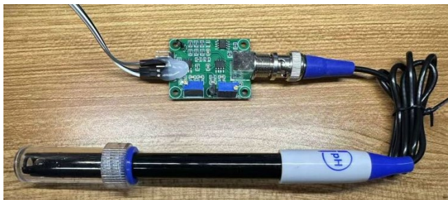
Figure 3. pH detection module 图 3. pH 检测模块
