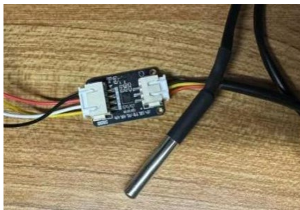
Figure 6. Temperature detection module 图 6. 温度检测模块
