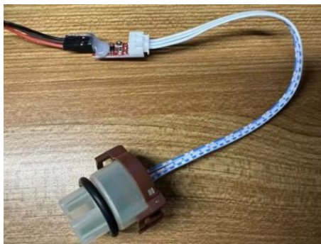
Figure 4. Turbidity detection module 图 4. 浊度检测模块
